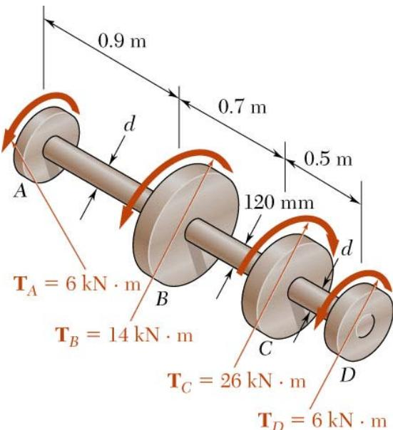
축 BC는 안지름 90 mm, 바깥지름 120 mm인 중공축이며 축 AB와 CD는 지름  $d$ 인 중실축이다. 그림과 같은 하중을 받을 때 다음을 구하여라. (a) 축 BC에서의 최대 및 최소전단응력, (b) 축의 허용전단응력이 65 MPa일 때 축 AB와 CD의 필요한 지름.
